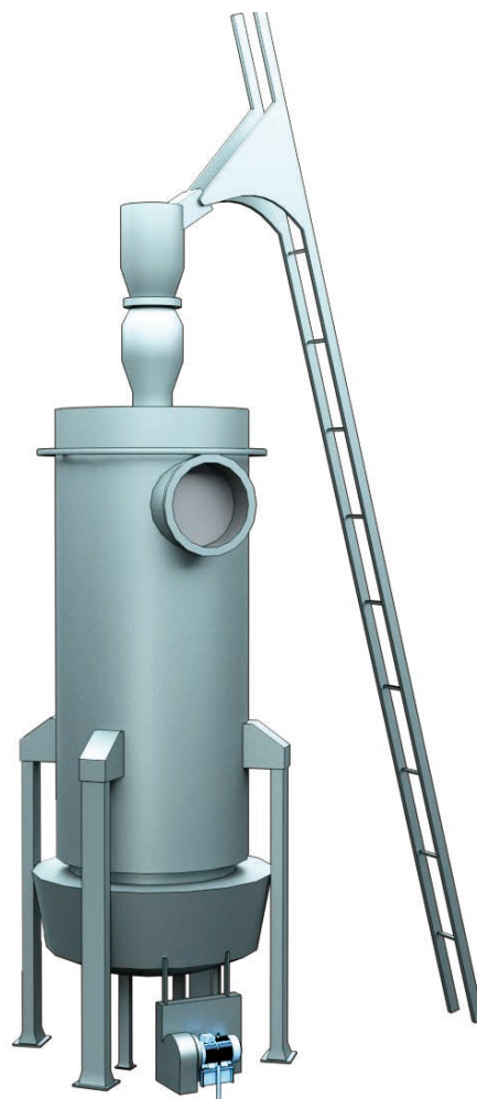
热发生炉煤气窑炉
