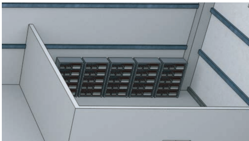
实体墙隔离的电池 ✓
