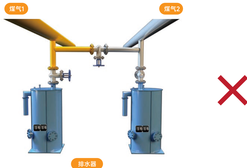
判定情形4 不同介质的煤气管道共用一个排水器
