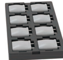
过充电电池-电压≥4.7V,通常胀气
