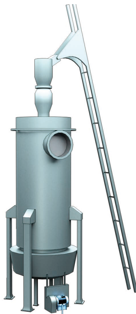
热发生炉煤气窑炉
